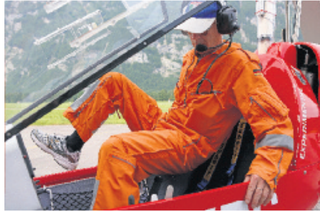
Peter Straub rollt den Gyrokopter auf die Landebahn in Mollis. Sobald die Startposition erreicht ist, bringt er mit dem Prerotator den Rotor auf Touren.
