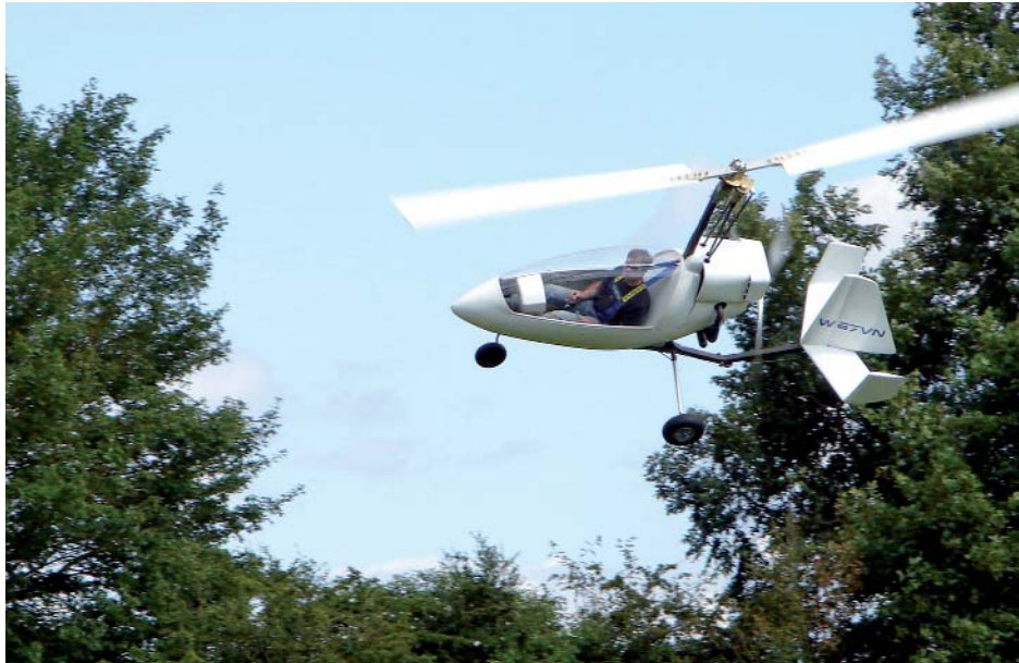
Der DF-02, wie er derzeit vom Glarner Peter Straub gebaut wird, ist ein einsitziger Gyro mit geschlossener Kabine.
